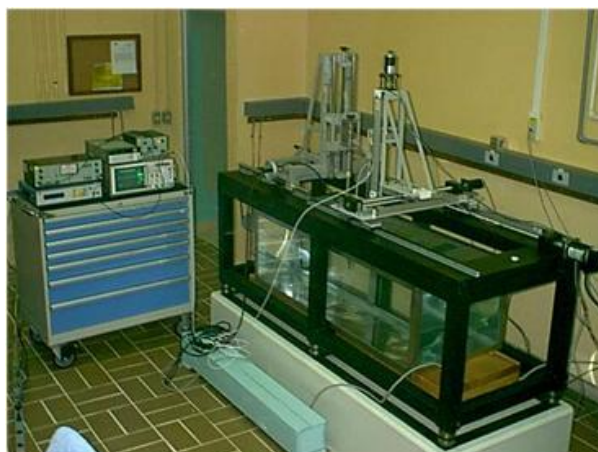
Figura 1. Sistema ultrasónico para inspección automática de componentes industriales por inmersión (CENAM).
